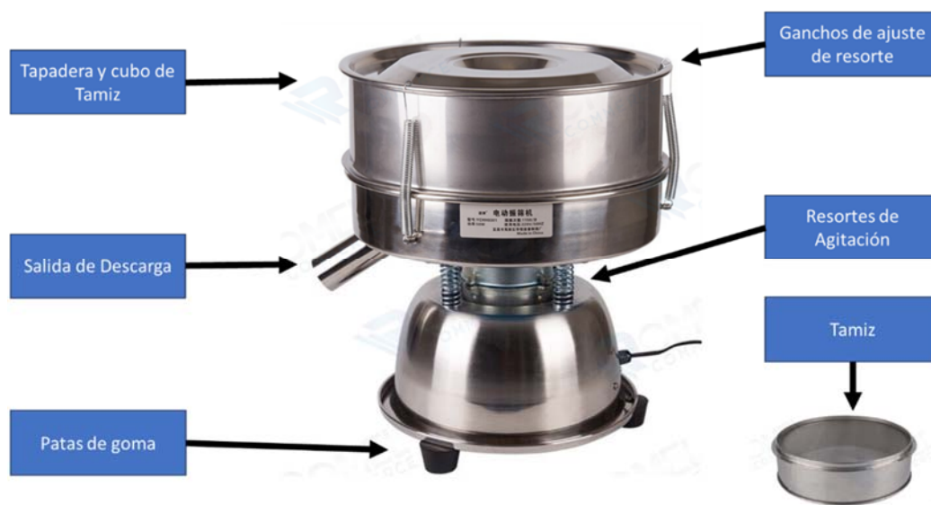
Figura 2 Máquina de Tamiz Automática, principales componentes.
